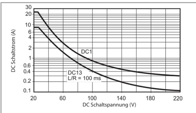
**H 66 - Gleichstromschaltvermögen bei DC1- und DC13-Belastung**
